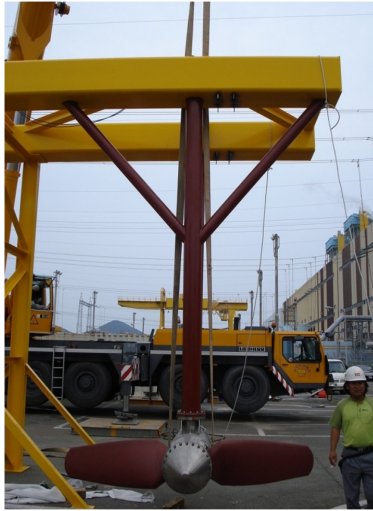
[그림 28] 25kW급 수평축 조류발전 장치
