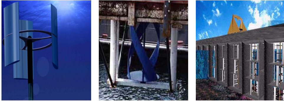
[그림 7] 수직축(VAT) 조류발전 시스템
