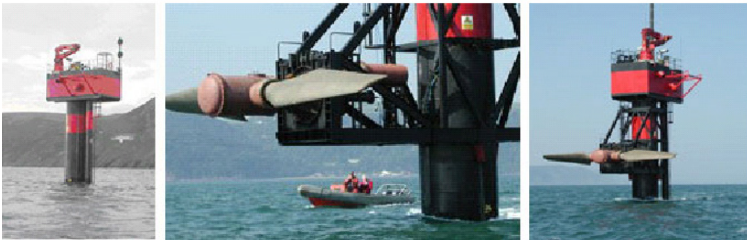
[그림 11] Seaflow 조류발전 장치
