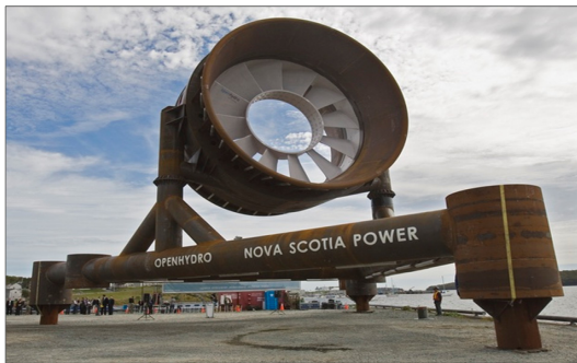
[그림 24] Open Hydro 조류발전 장치
