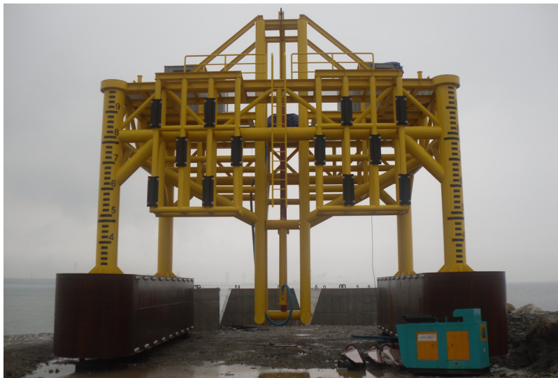
[그림 29] 100kW급 부유식 조류발전 장치
