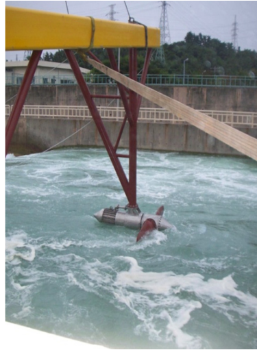
[그림 28] 25kW급 수평축 조류발전 장치
