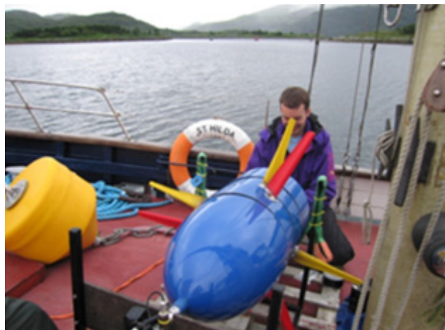
[그림 19] Nautiricity사 조류발전 장치
